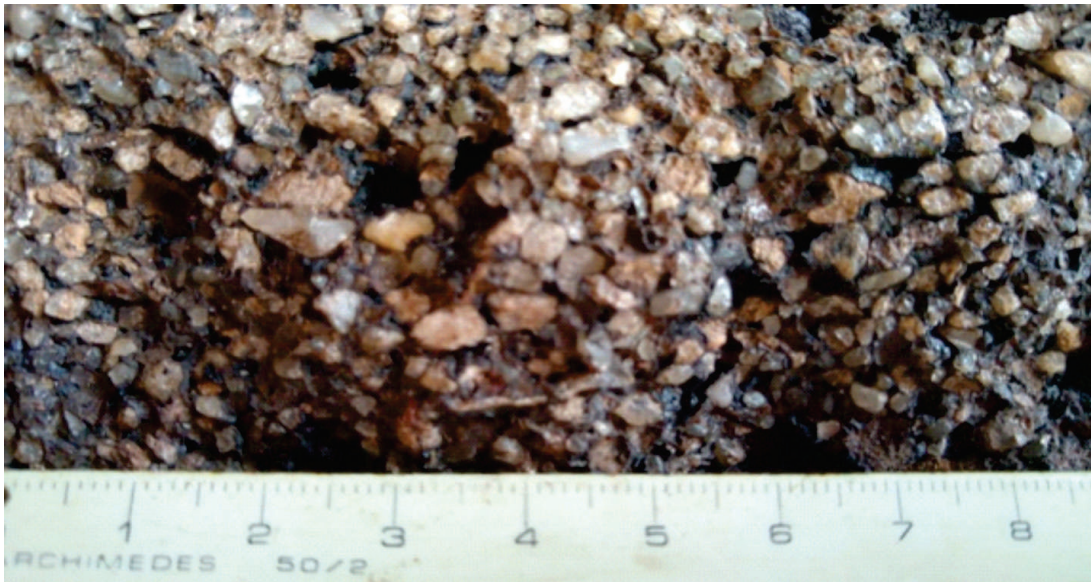
Figura 4. Detalhe da estrutura do conglomerado ferruginoso laterítico da jazida 19 do Maracujá, tendo uma régua branca como escala e assim dando ideia da proporcionalidade entre a matriz quartzosa, o arcabouço e o cimento ferruginoso. Rocha sedimentar do tipo conglomerado ferruginoso laterítico, cujo arcabouço é constituído por uma fração clástica principal de grãos de quartzo cristalino e leitoso, sendo angulosos, com diâmetros variáveis de 0,6mm a 0,07mm, em cuja foto se verifica o arranjo da distribuição espacial dos grãos com contatos pontuais. A matriz da rocha é perfeitamente visível nas figuras posteriores e que se traduz por um material constituído de finas partículas de quartzo aglutinadas por um cimento ferruginoso, que em conjunto sustentam o arcabouço estrutural da rocha. O cimento da rocha é constituído de óxidos minerais (hematita, gohetita) sendo responsável pela resistência físico mecânica da rocha, o que a torna aproveitável na produção de agregado para utilização no concreto de cimento Portland. A rocha conglomerática, assim como o cimento estão submetidos a uma degradação de resistência em face ao intemperismo diferencial.
